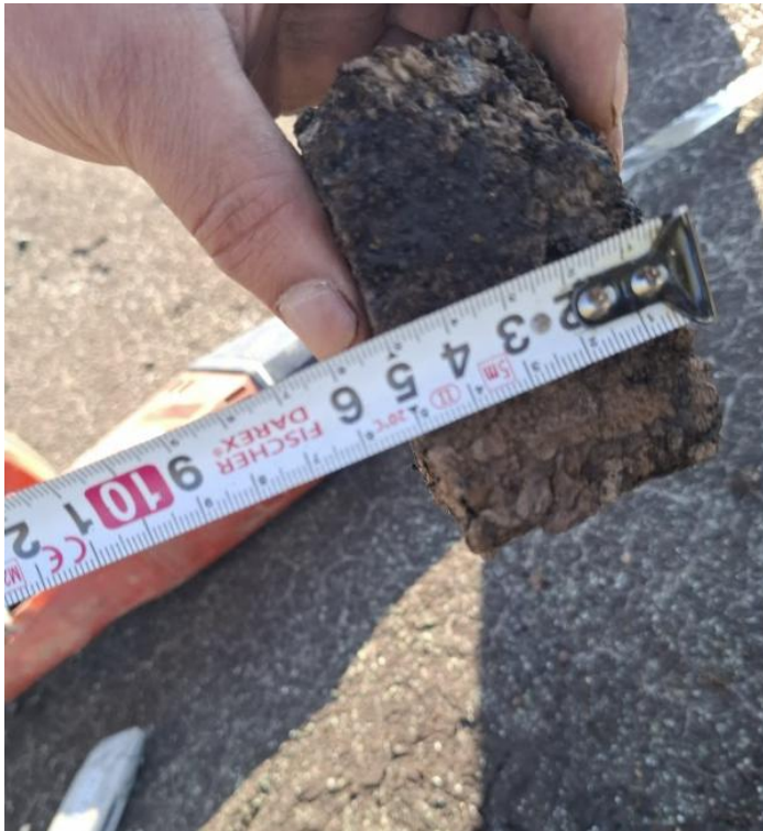
Le sondage met en évidence un monocouche sur un isolant en liège, à remplacer Celui-ci à une épaisseur de 50 mm sur un support béton.
